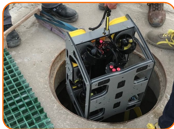
Inspecciones subacuáticas con Remote Operated Vehicle (ROV).
